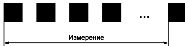
Рисунок 34 — Пример измерения шага пикселей
