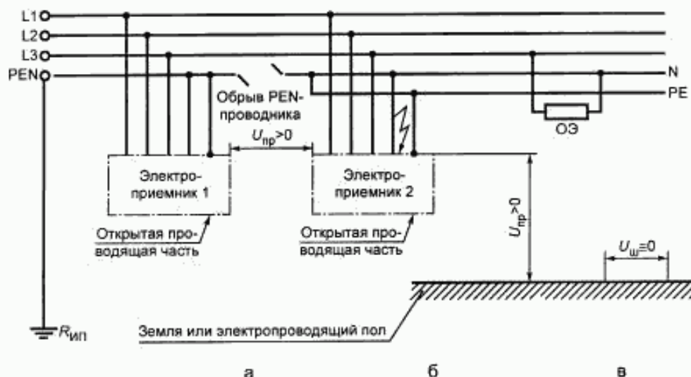
Рисунок В.7 — Сеть TN-C-S с обрывом PEN-проводника
