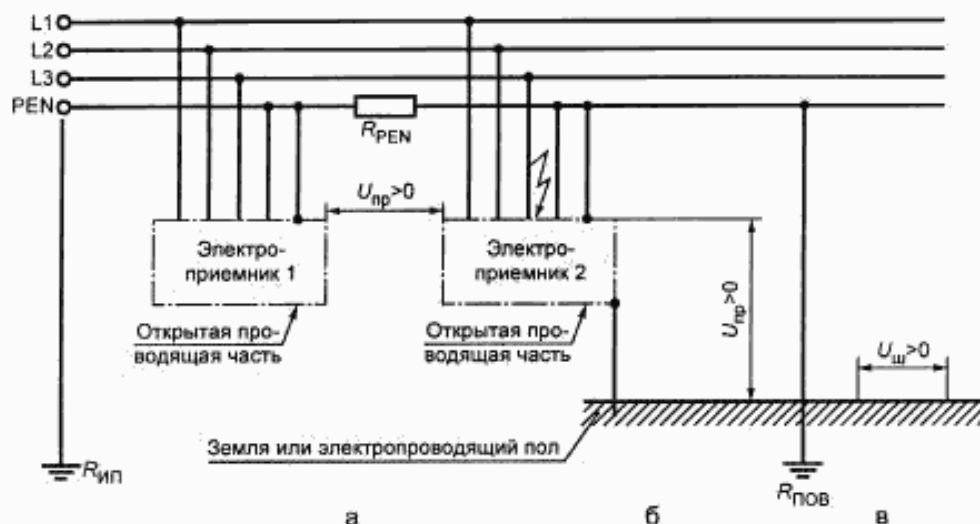
Рисунок В.3 — Сеть TN-C с однофазным замыканием на корпус Здесь и на следующих рисунках уравнивание и выравнивание потенциалов отсутствуют U_{пр} — напряжение прикосновения; U_{ш} — шаговое напряжение; R_{ИП} — заземлитель источника питания; R_{пов} — заземлитель для повторного заземления PEN-проводника; R_{PEN} — полное сопротивление PEN-проводника
