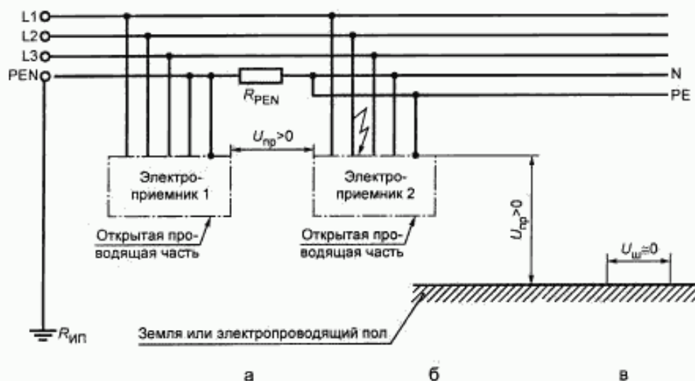
Рисунок В.8 — Сеть TN-C-S с однофазным замыканием на корпус после точки разделения PEN-проводника на N- и PE-проводники
