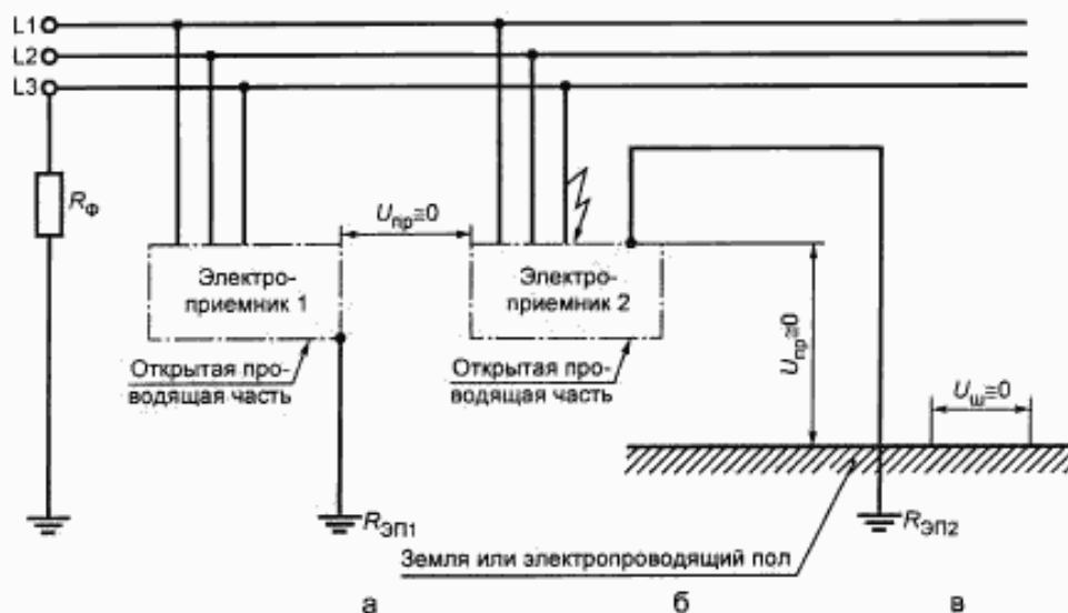
Рисунок В.13 — Сеть IT с заземлением фазы источника питания через сопротивление с однофазным замыканием на корпус
