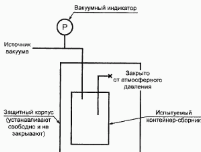
Рисунок 8 — Испытание контейнера-сборника на разрыв
