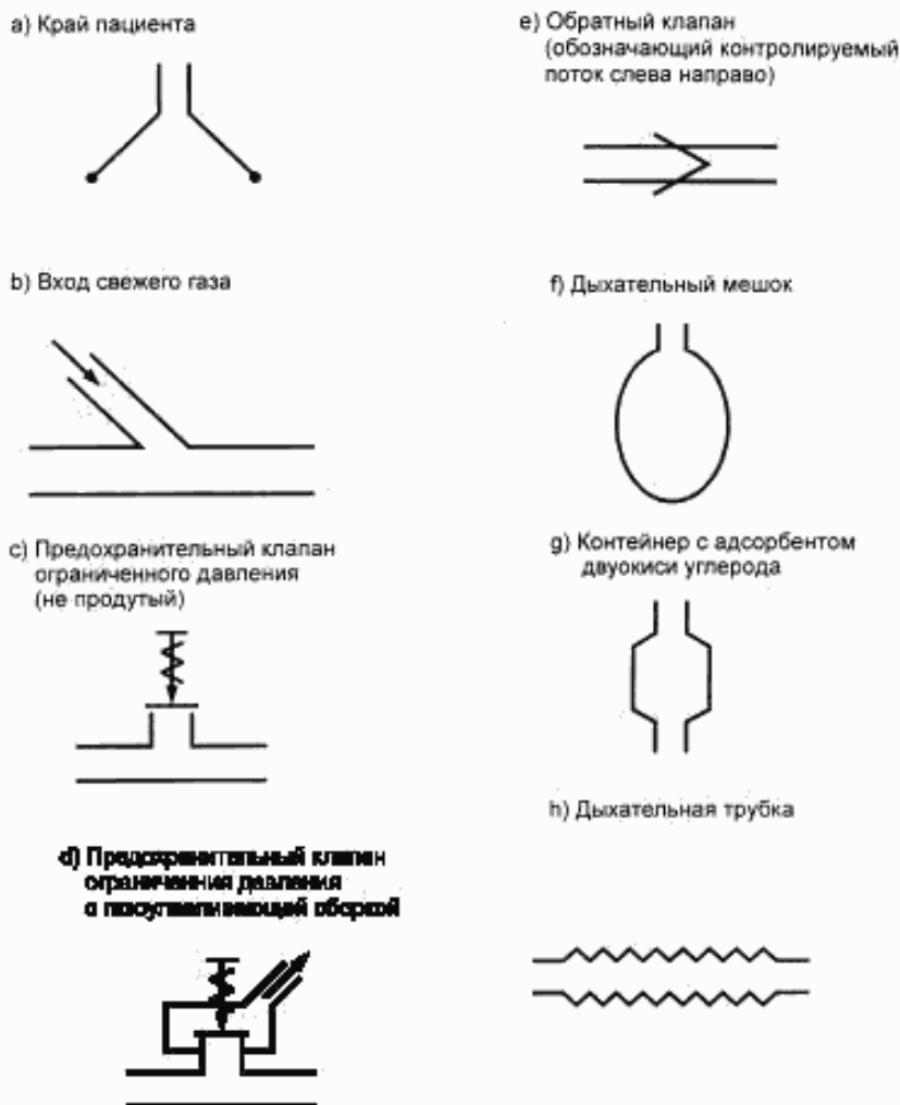
Рисунок В.1 — Условные обозначения и пояснения для дыхательных приспособлений, изображенных на рисунках В.2 и В.3 (Лист 1)
