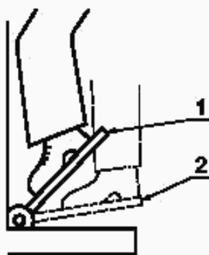
1 — тормоз зажат; 2 — тормоз отпущен
