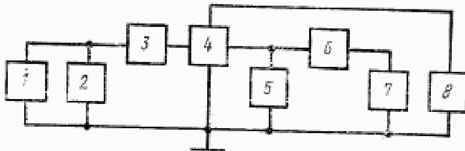
1—генератор постоянного напряжения; 2, 5—измерители напряжения; 3, 6—измерители тока; 4—переключатель; 7—генератор постоянного тока; 8—блок питания.
