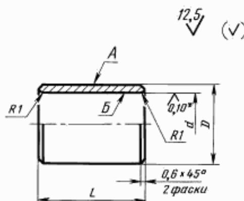
\* Для втулок с предельным отклонением диаметра  $d$  по H7 — параметр шероховатости поверхности  $Ra = 0,40$  мкм.
