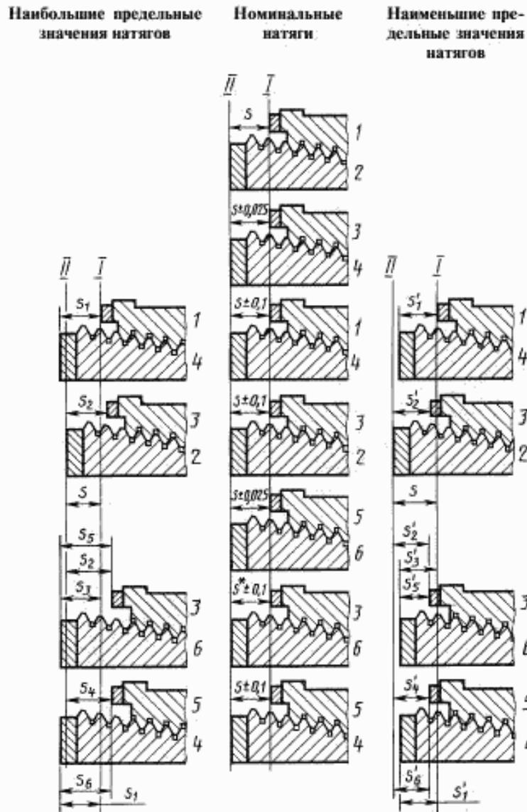
\* Взаимозаменяемый натяг рабочего калибра-пробки у изготовителя рекомендуется принимать  $\pm 0,025$  мм.
