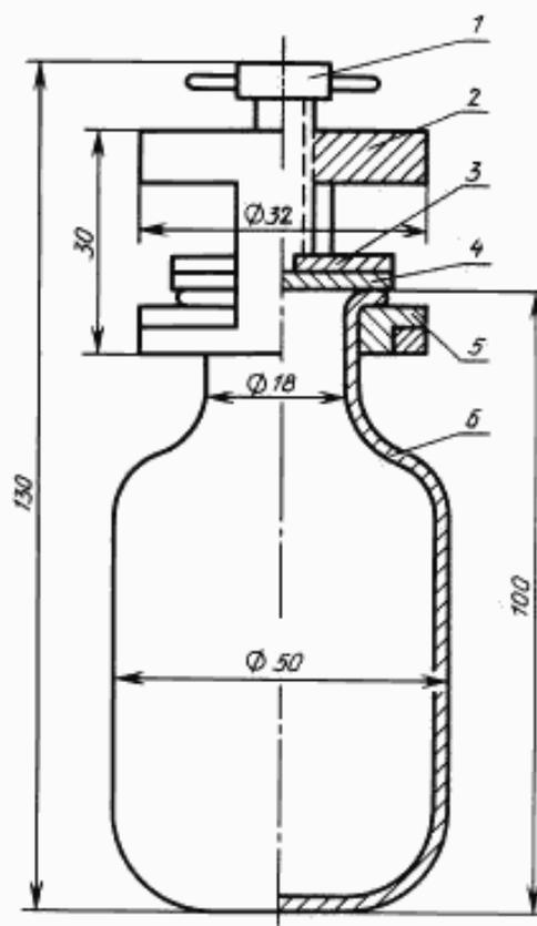
1 — винт М6 × 24 из стали 35; 2 — корпус из стали 3; 3 — шайба  $\delta = 4$  из стали 35; 4 — прокладки  $\delta = 3$  из бензостойкой резины и фторопластовой пленки; 5 — сухарик из текстолита; 6 — колба вместимостью  $(100 \pm 15)$  см<sup>3</sup>
