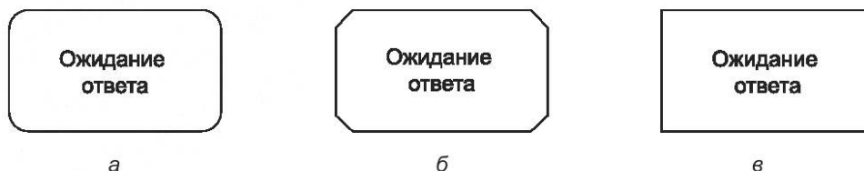
Рисунок 39 — Варианты изображения простого состояния
