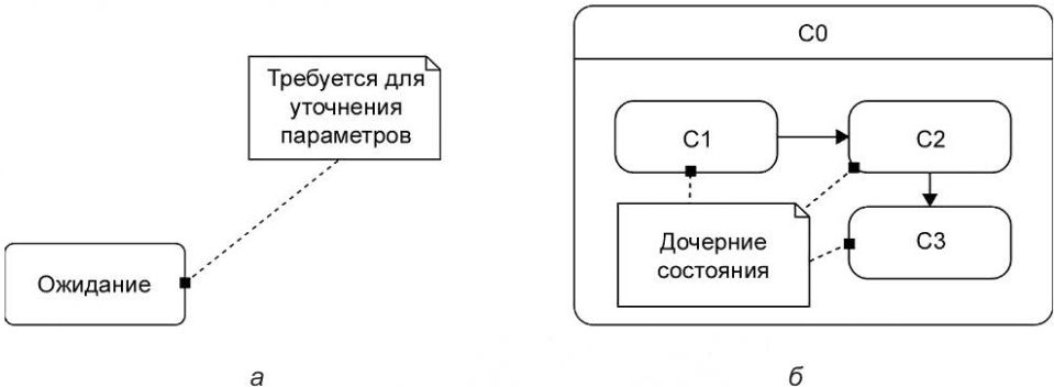
Рисунок 6 — Связь комментария одного (а) или более (б) с предметами комментирования — элементами
