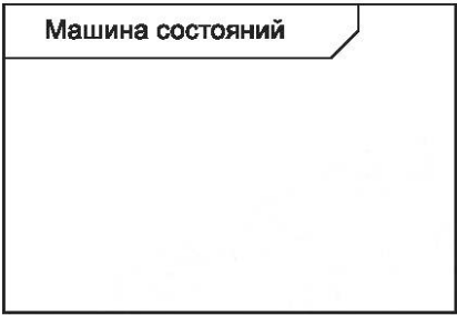
Рисунок 12 — Обозначение машины состояний
