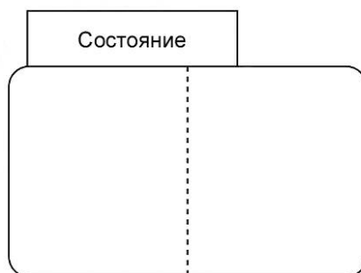
Рисунок 16 — Обозначение для составного состояния с двумя областями
