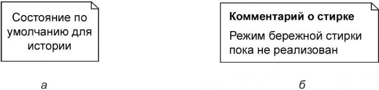
Рисунок 5 — Комментарий без имени (а) и с именем (б) в виде отдельного блока
