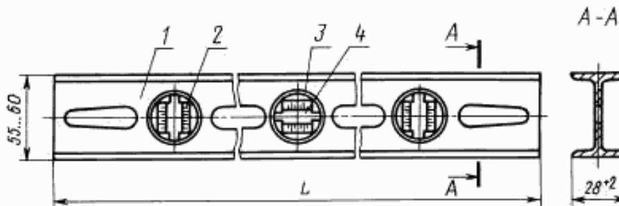
1 — корпус; 2 — ампула; 3 — блок; 4 — защитное стекло
