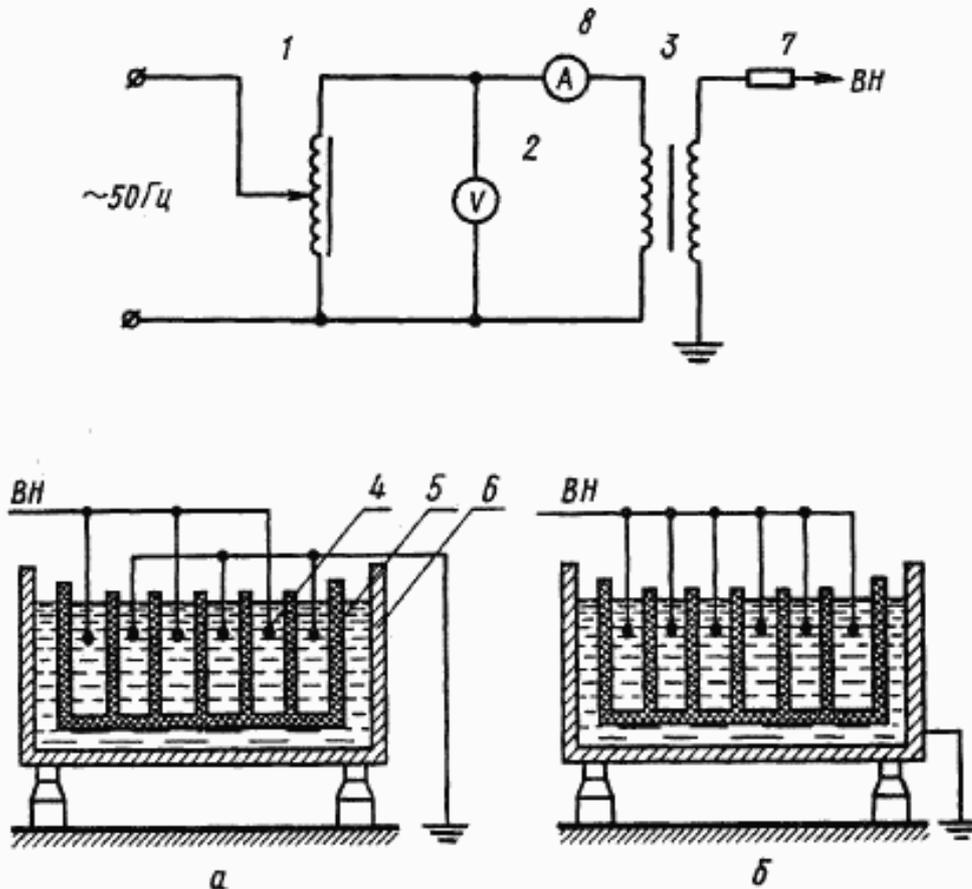
*а* — схема подключения электродов к источнику высокого напряжения при испытании перегородок моноблока; *б* — схема подключения электродов к источнику высокого напряжения при испытании корпуса моноблока.
