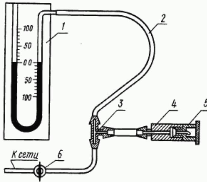
1 — образцовый манометр типа МО или манометр сильфонный типа МС;
