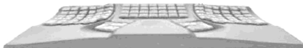
Рисунок 7 – Пример клавиатуры с рельефным профилем
