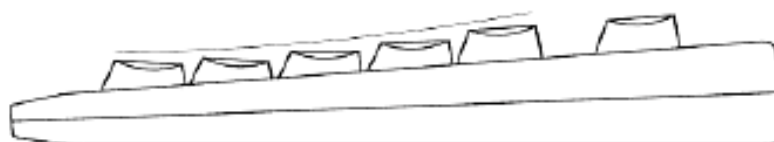
Рисунок 4 – Пример клавиатуры с вогнутым профилем
