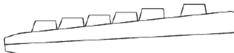
Рисунок 8 – Пример клавиатуры со ступенчатым профилем
