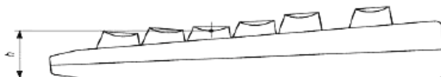
Рисунок 2 – Стандартная клавиатура. Высота основного ряда
