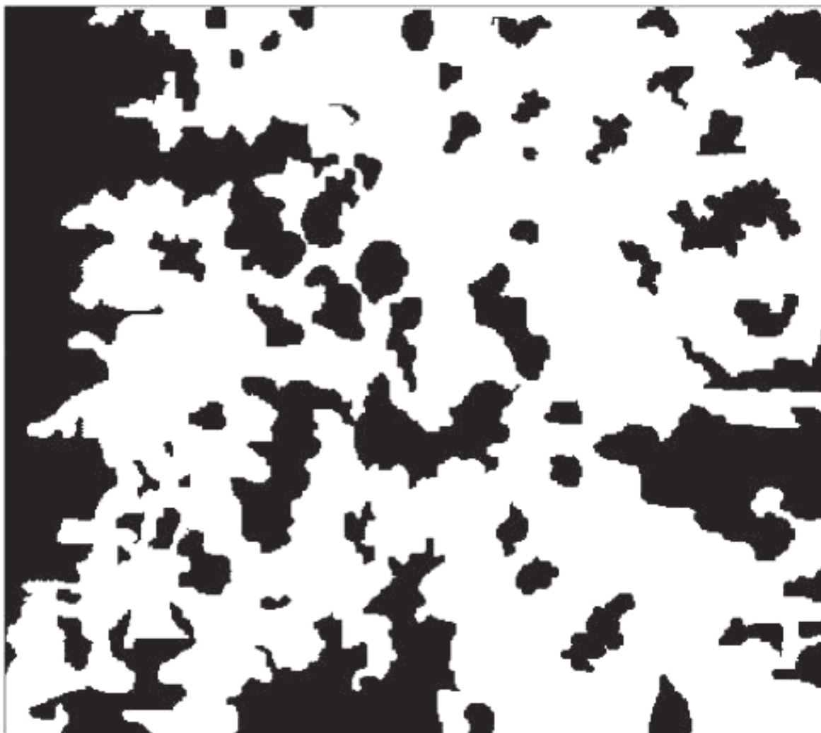
Рисунок Ж.5 — Коррозия металла, балл К5 (или R/5)
