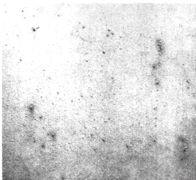
Рисунок 10 — Коррозия металла балл K2 (или Ri2)
