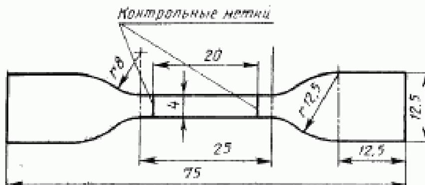
Рисунок 3 — Образец в форме лопатки
