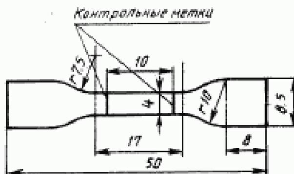
Рисунок 4 — Образец в форме лопатки
