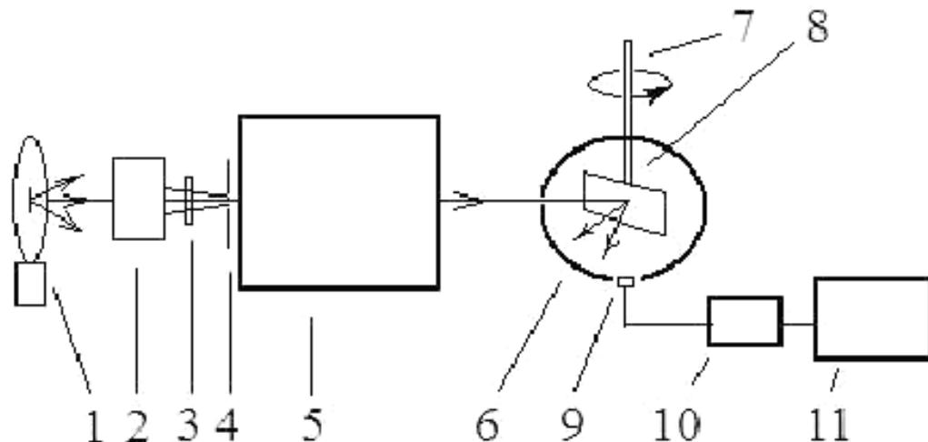
1 – лампа; 2 – конденсор; 3 – спектральный фильтр; 4 – входная щель; 5 – монохроматор;
