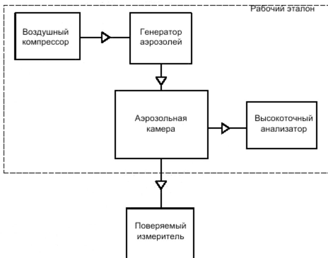
Рисунок А.1 – Схема поверки измерителей
