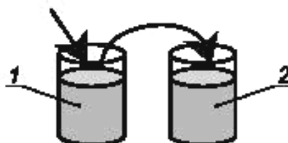
1 — стакан с пробой моторного топлива (промывка); 2 — стакан с пробой моторного топлива (измерение)
