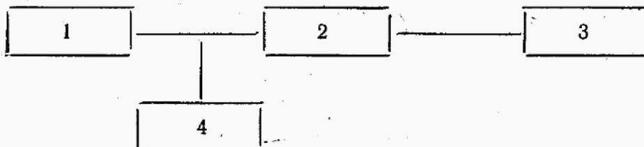
1—источник постоянных напряжений; 2—образцовый делитель напряжения;
