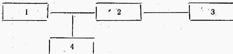
1—источник постоянных напряжений; 2—образцовый делитель напряжения;
