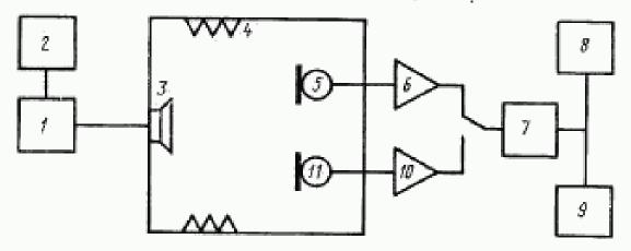
/—генератор; 2—частотомер; 3—громкоговоритель; 4—заглушевная камера; 5 в //—образцовый в поверяемый явкрофоны; 6 в //о—микрофонные усилятеля; 7—магазив затухания; 8—электронный вольтметр; 9—осциялограф.
