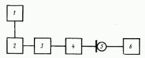
I—частотомер; 2—генератор; 3—магазин затухания; 4—электростатический возбудитель; 5—повернемый микрофон; 6—электронный вольтметр.
