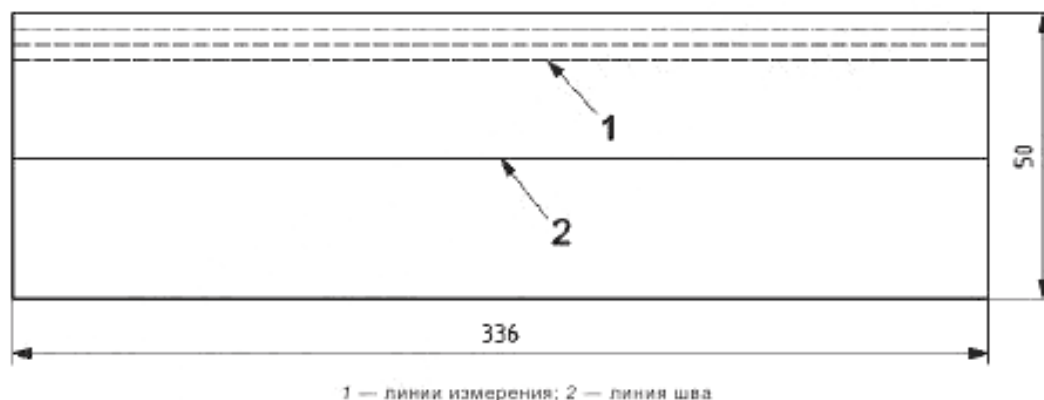
Рисунок А.2 — Область измерений эталона шва
