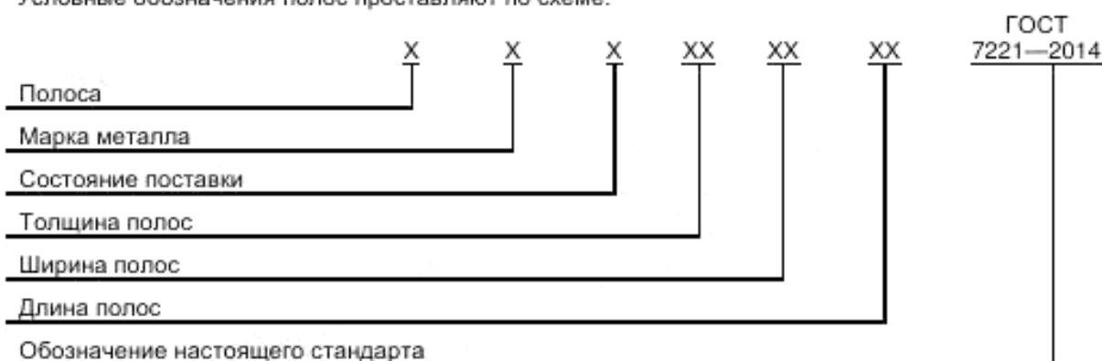
При этом используют следующие сокращения для обозначения состояния поставки: М — мягкое, Т — твердое.
