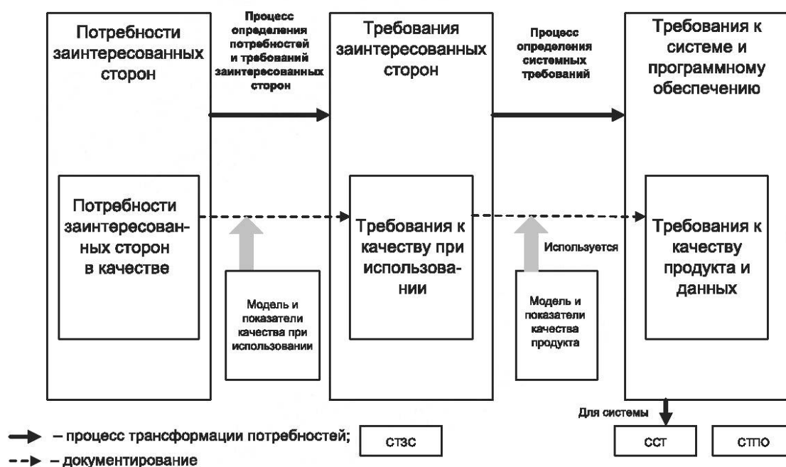
Рисунок 5 — Процесс преобразования потребностей заинтересованных сторон в требования к системе/программному обеспечению
