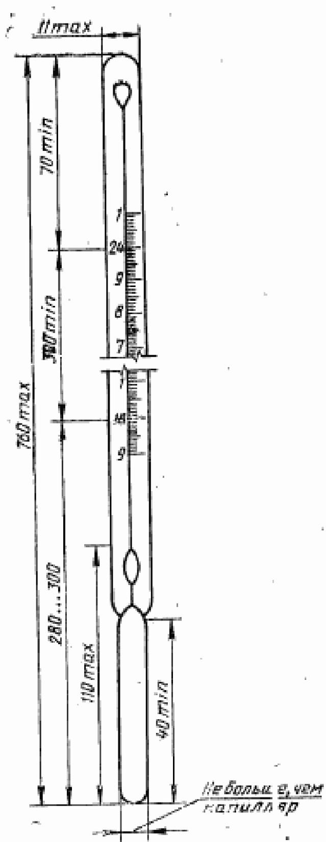
Рисунок 1 — Термометр палочный калориметрический
