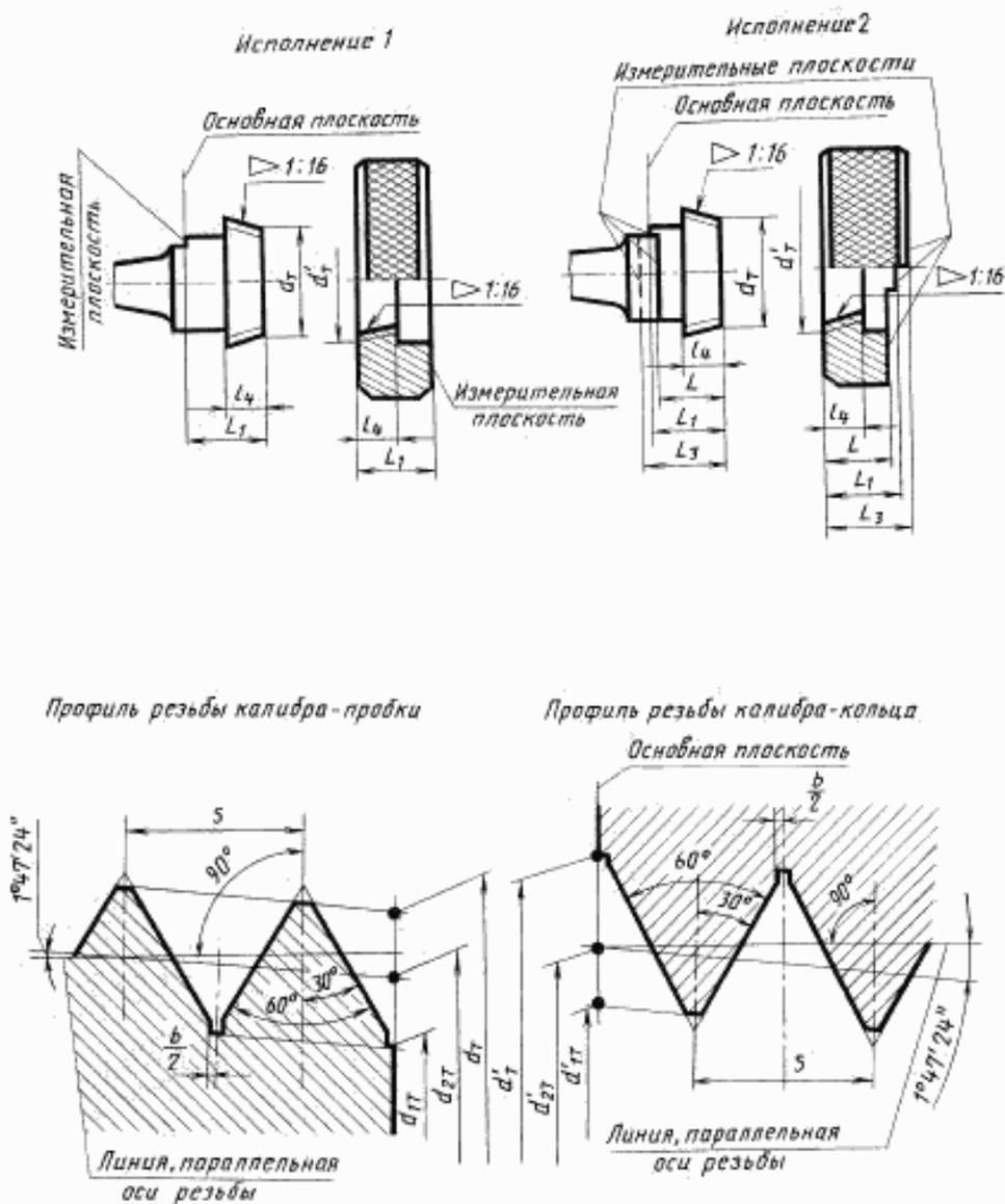
Шаг измеряется параллельно оси резьбы. Биссектриса угла профиля перпендикулярна к оси резьбы. Форма проточки по впадинам — произвольная.
