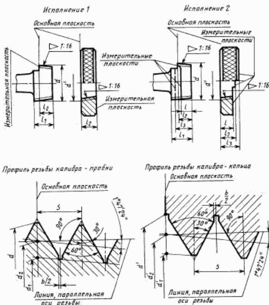
Шаг измеряется параллельно оси резьбы. Биссектриса угла профиля перпендикулярна к оси резьбы. Форма проточки по впадинам — произвольная.
