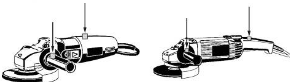
Рисунок I.102 — Расположение измерительных преобразователей для угловых шлифовальных машин
