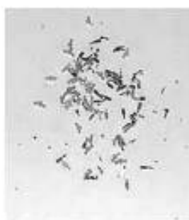
Рисунок Е.9б — Металлические выводы после разделения
