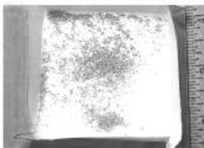
Рисунок Е.12 — Материал шариков припоя, собранный из корпуса BGA посредством процедуры удаления вручную
