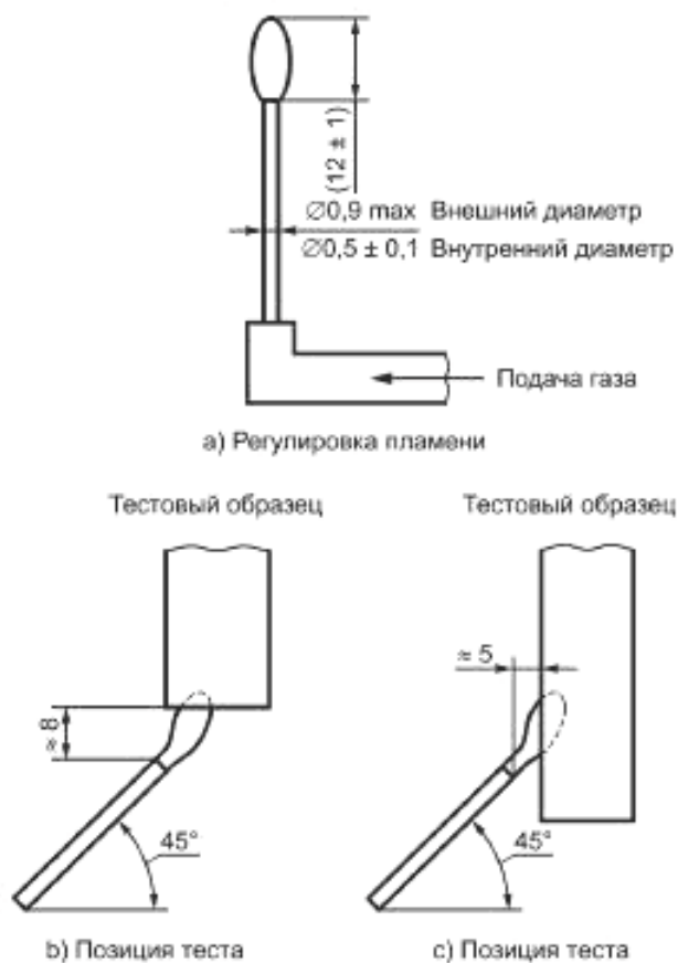
Рисунок В.3 — Детали испытания игольчатым пламенем
