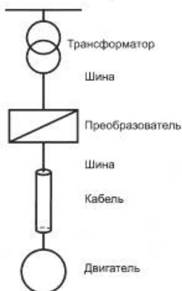
Рисунок Е.3 — Пример электрического привода
