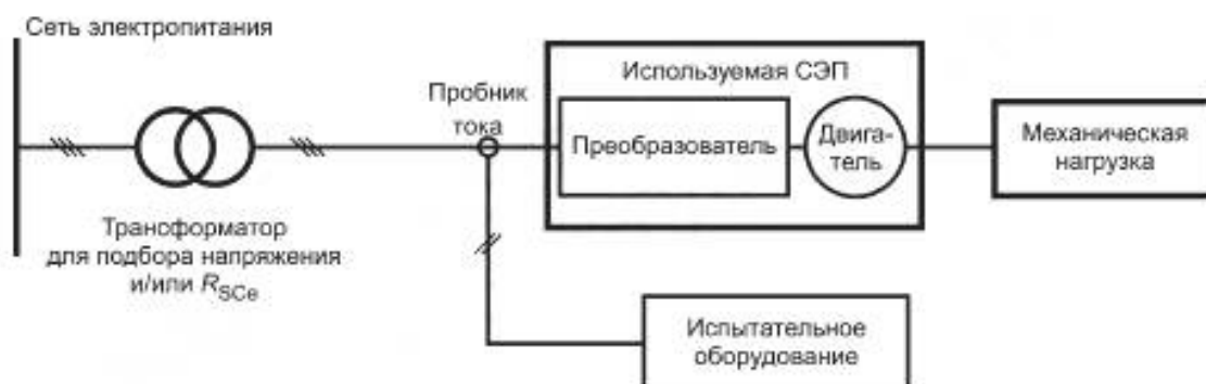
Рисунок В.6 — Испытательная установка с механической нагрузкой
