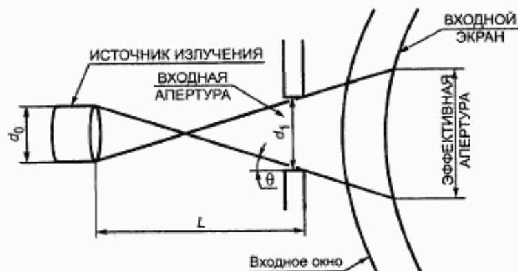
Рисунок 1 — Схема расположения ИСТОЧНИКА ИЗЛУЧЕНИЯ и ВХОДНОЙ АПЕРТУРЫ
