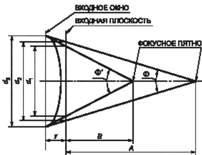
$d_1$  — РАЗМЕР РАБОЧЕГО ВХОДНОГО ПОЛЯ, соответствующий углу  $\Phi/2$  (т. е. РИВ =  $B$ ), см;  $d_2$  — РАЗМЕР РАБОЧЕГО ВХОДНОГО ПОЛЯ, соответствующий углу  $\Phi/2$  (т. е. РИВ =  $A$ ), см;  $d_3$  — НОМИНАЛЬНЫЙ РАЗМЕР ВХОДНОГО ПОЛЯ УРИ в входном окне, см
