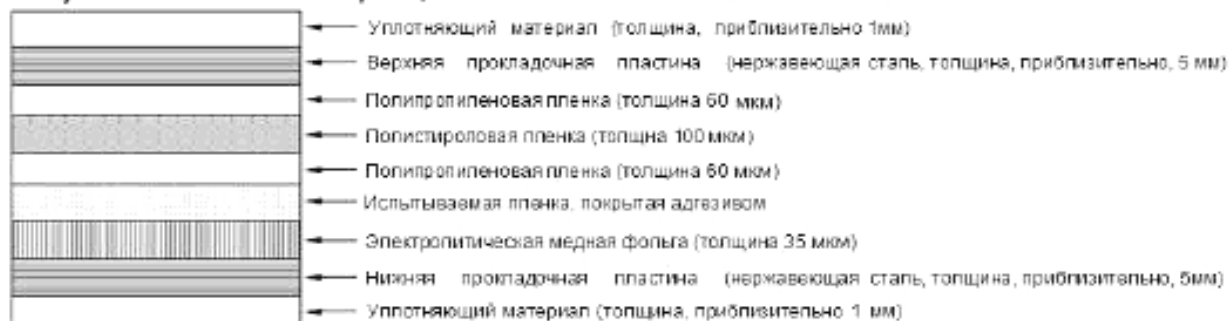
Рисунок 20 — Стандартная укладка слоев материалов в прессе при подготовке образца к арбитражным испытаниям
