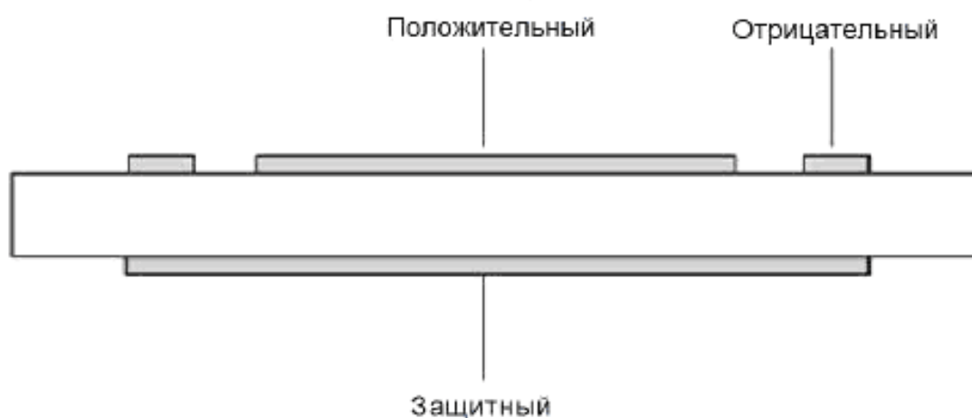
Рисунок 26 — Подсоединения электродов для измерения поверхностного сопротивления
