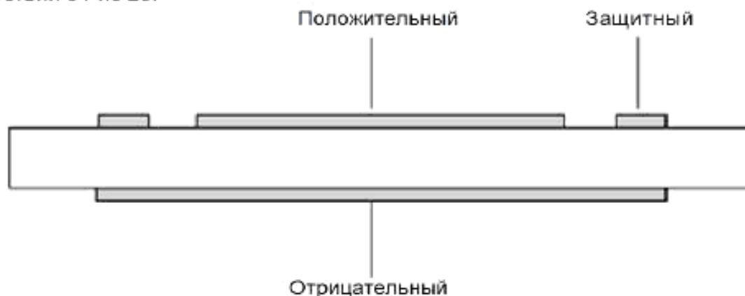
Рисунок 25 — Подсоединения электродов для измерения объёмного сопротивления
