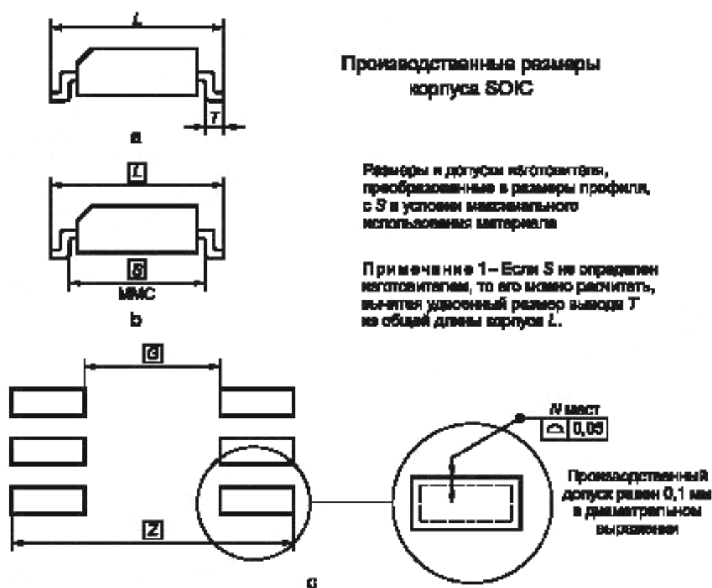
Рисунок 3 — Определение размеров профиля корпуса SOIC с выводами в форме крыла чайки
