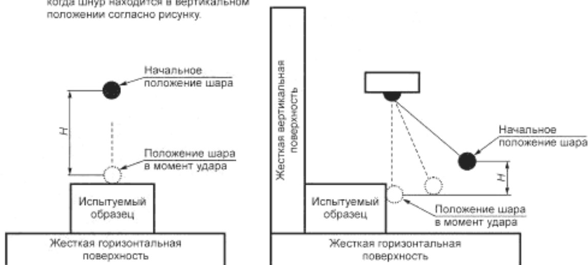
Рисунок 12 — Метод испытаний на ударостойкость
