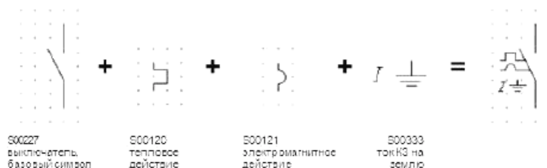
Рисунок А.7 – Символическое представление автоматического микровыключателя с устройством остаточного тока, вариант 1
