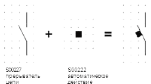
Рисунок А.3 – Микровыключатель, представленный комбинацией базового символа переключателя и спецификатора, подчеркивающего автоматическое срабатывание
