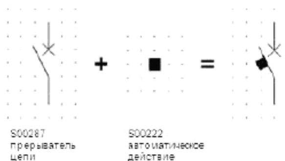
Рисунок А.4 – Микровыключатель, показанный как комбинация символа прерывателя цепи и спецификатора, подчеркивающего автоматическое срабатывание
