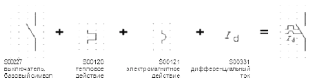
Рисунок А.8 – Символическое представление автоматического микровыключателя с устройством остаточного тока, вариант 2
