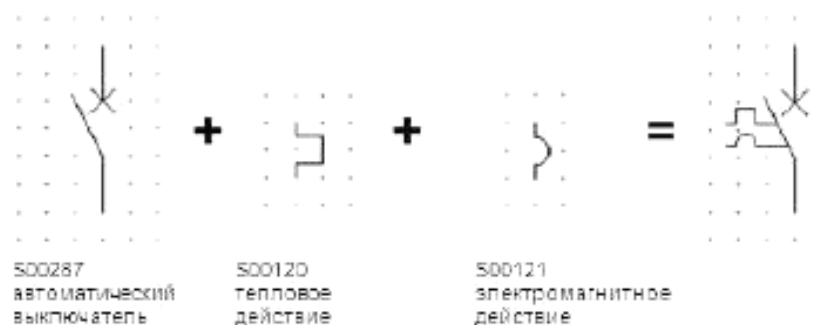
Рисунок А.6 – Микровыключатель, показанный как комбинация символа автоматического выключателя и спецификаторов теплового и электромагнитного эффектов
