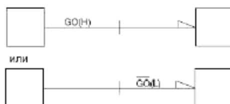
Рисунок 76 – Примеры указателей несовпадения полярности
