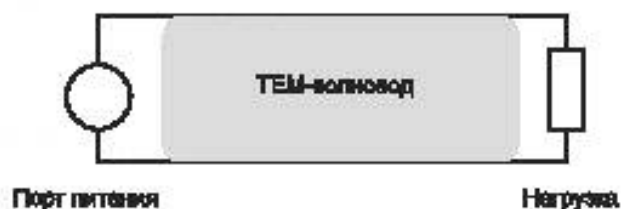
Рисунок D.4 — Модель передающей линии для распространения ТЕМ-вида колебаний
