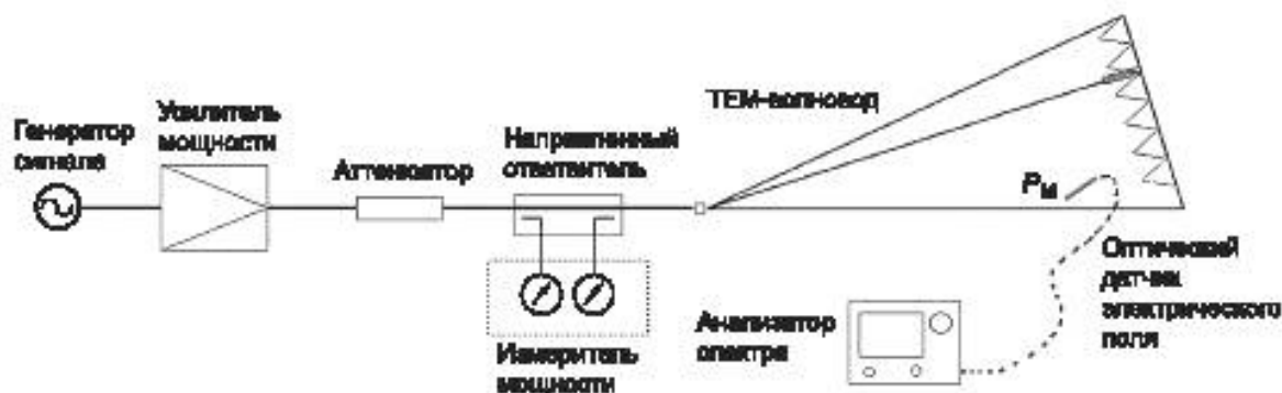
Рисунок E.5.b — Применение небольшого датчика электрического поля
