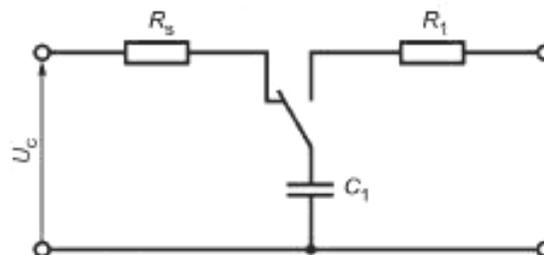
Рисунок N.2 — Схема испытательного генератора импульсов по IEC 60065
