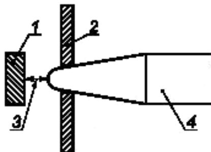
1 — внутренняя проводящая часть; 2 — кожух; 3 — воздушный зазор между испытательным пальцем или испытательным штырем и внутренней проводящей частью; 4 — испытательный палец или испытательный штырь
