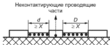
Условие: расстояние изоляции с интервалом; проводящая часть не имеет соединения.
