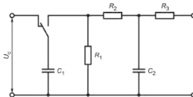
Рисунок N.1 — Схема испытательного генератора импульсов МСЭ-T
