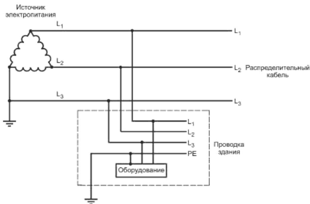
Заземленная фаза и независимое заземление оборудования
