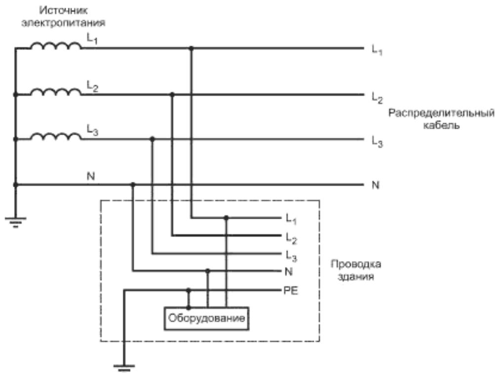
Заземленная нейтраль и независимое заземление оборудования
