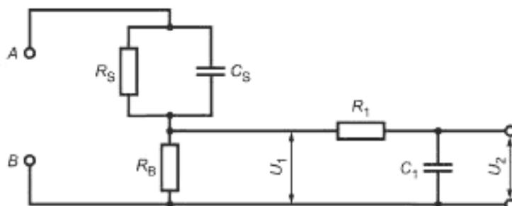
A, B — клеммы;  $R_S = 1500 \text{ Ом}$ ;  $R_B = 500 \text{ Ом}$ ;  $R_1 = 10 \text{ кОм}$ ;  $C_S = 0,22 \text{ мкФ}$ ;  $C_1 = 0,022 \text{ мкФ}$
