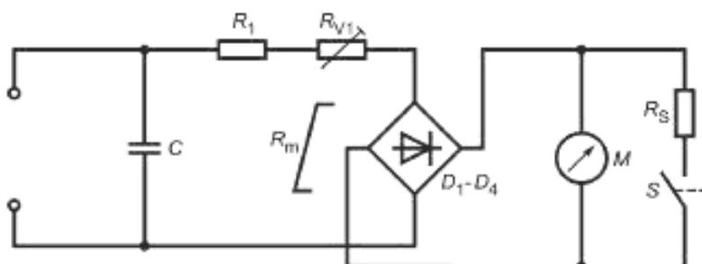
$M$  — головка магнитоэлектрической системы с подвижной катушкой (диапазон измерений до 1 мА);  $R_1 + R_{V1} + R_m$  (при постоянном токе 0,5 мА) = 1500 Ом  $\pm$  1 % с  $C = 150 \text{ нФ}$   $\pm$  1 % или 2000 Ом  $\pm$  1 % с  $C \pm 112 \text{ нФ}$   $\pm$  1 %;  $D_1 - D_4$  — диодный мост (выпрямитель);  $R_S$  — безындуктивный шунт для десятикратного расширения диапазона измерений;  $S$  — переключатель предела измерений (максимальный предел в положении «включено»)
