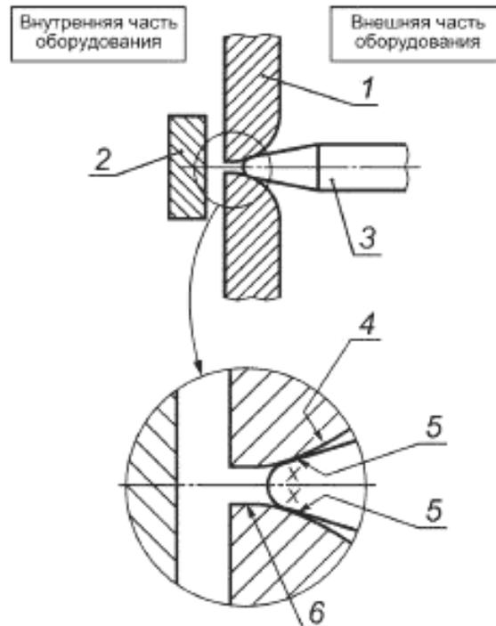
1 — кожух из изоляционного материала; 2 — внутренняя проводящая часть; 3 — испытательный палец; 4 — поверхность, считающаяся покрытой металлической фольгой и доступная для испытательного пальца; 5 — точка контакта; 6 — недоступная для испытательного пальца поверхность
