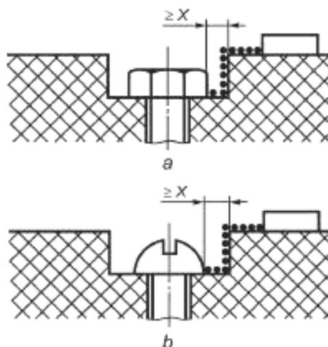
Зазор между головкой винта и стенкой выемки достаточно велик и должен быть учтен.
