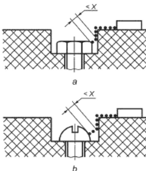
Зазор между головкой винта и стенкой выемки слишком мал, чтобы его учитывать.
