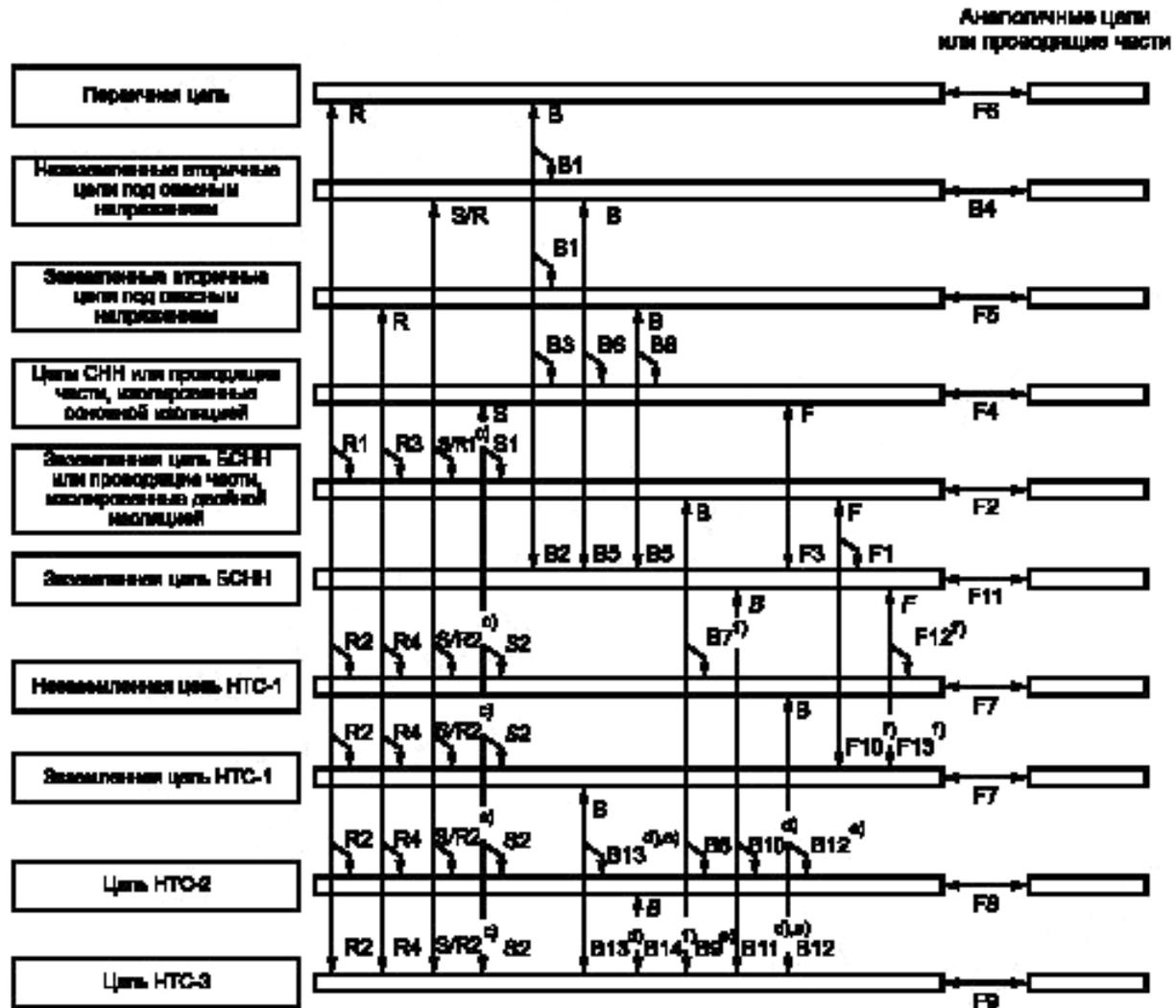
F — функциональная изоляция; B — основная изоляция; R — усиленная изоляция; S — дополнительная изоляция; S/R — см. сноску <sup>c)</sup> в таблице 2Н
