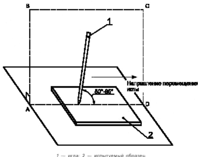
Рисунок 2К — Испытание покрывающего слоя на износостойкость
