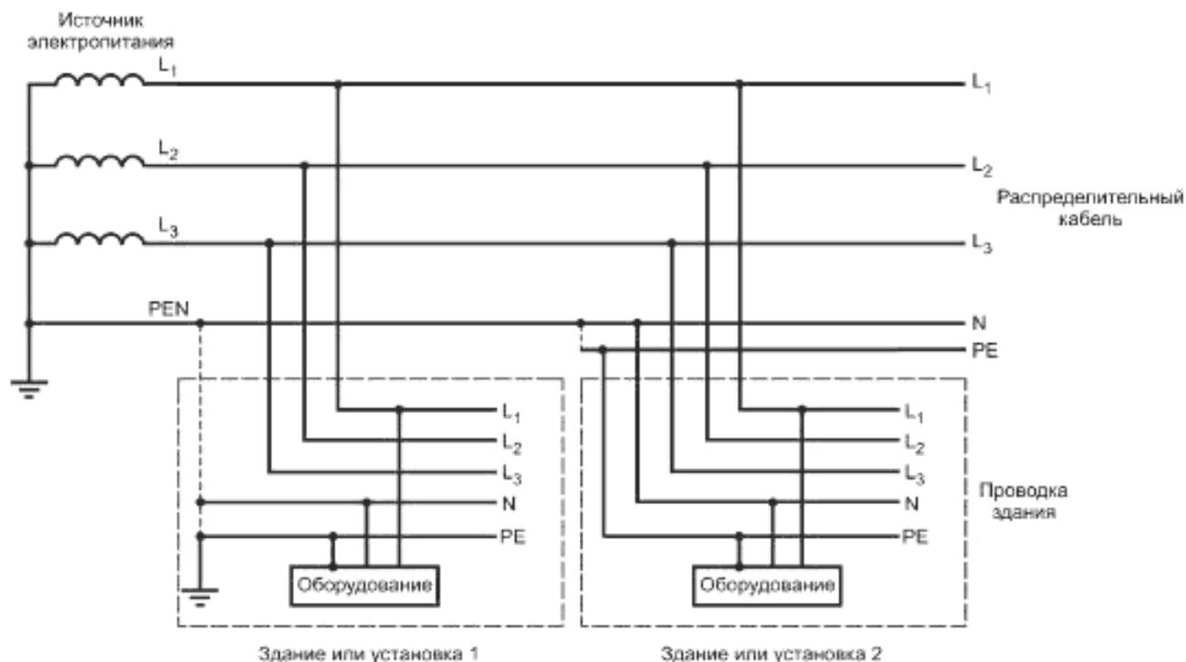
Один провод (PEN) объединяет в себе функции нейтрального и защитного проводов в одной из частей системы
