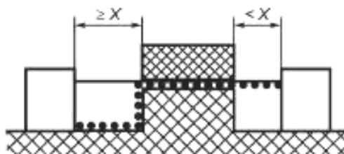
Условие: рассматриваемый путь включает в себя нескрепленный стык с канавкой с одной стороны, имеющей ширину менее  $X$  мм, и с канавкой с другой стороны, имеющей ширину не менее  $X$  мм.
