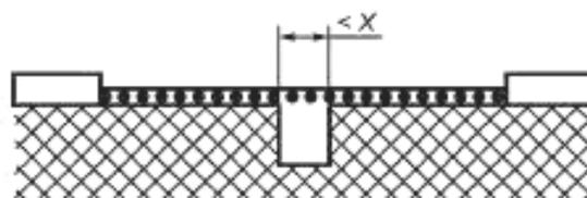
Условие: рассматриваемый путь включает в себя канавку с параллельными или под углом сторонами, любой глубины, шириной менее  $X$  мм.
