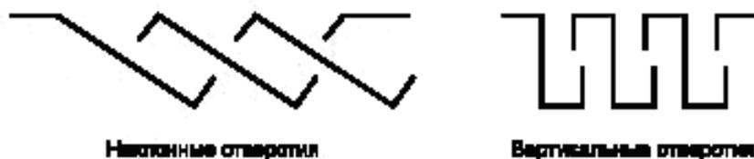
Рисунок 4B — Примеры поперечного сечения конструкции отверстий
