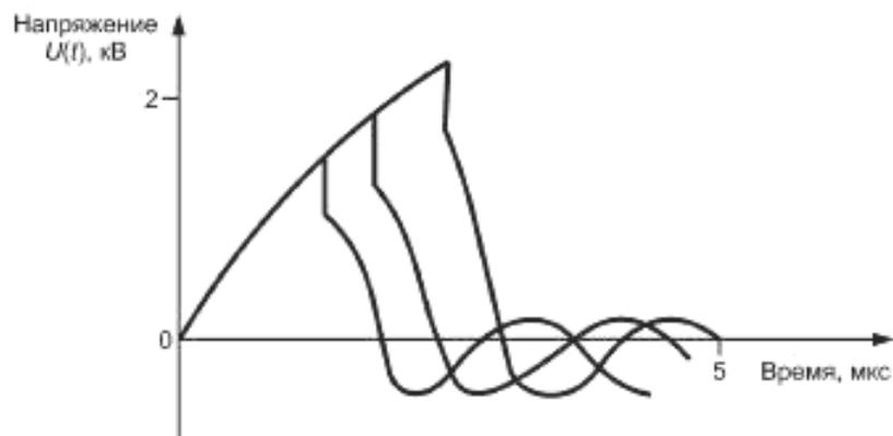
Последовательные импульсы не повторяются по форме. Форма каждого импульса изменяется вследствие пробоя изоляции. Пробой четко виден на осциллограмме импульсного напряжения.
