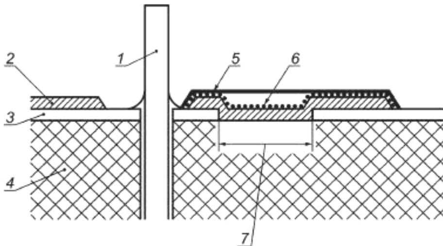
1 — вывод компонента; 2 — покрытие; 3 — медная дорожка; 4 — основание печатного монтажа; 5 — зазор по 2.10.3; 6 — путь утечки по 2.10.4; 7 — разделяющее расстояние перед покрытием по 2.10.6.2, таблица 2Q
