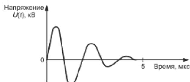
Рисунок S.4 — Форма сигнала при короткозамкнутых ограничителе перенапряжений и изоляции
