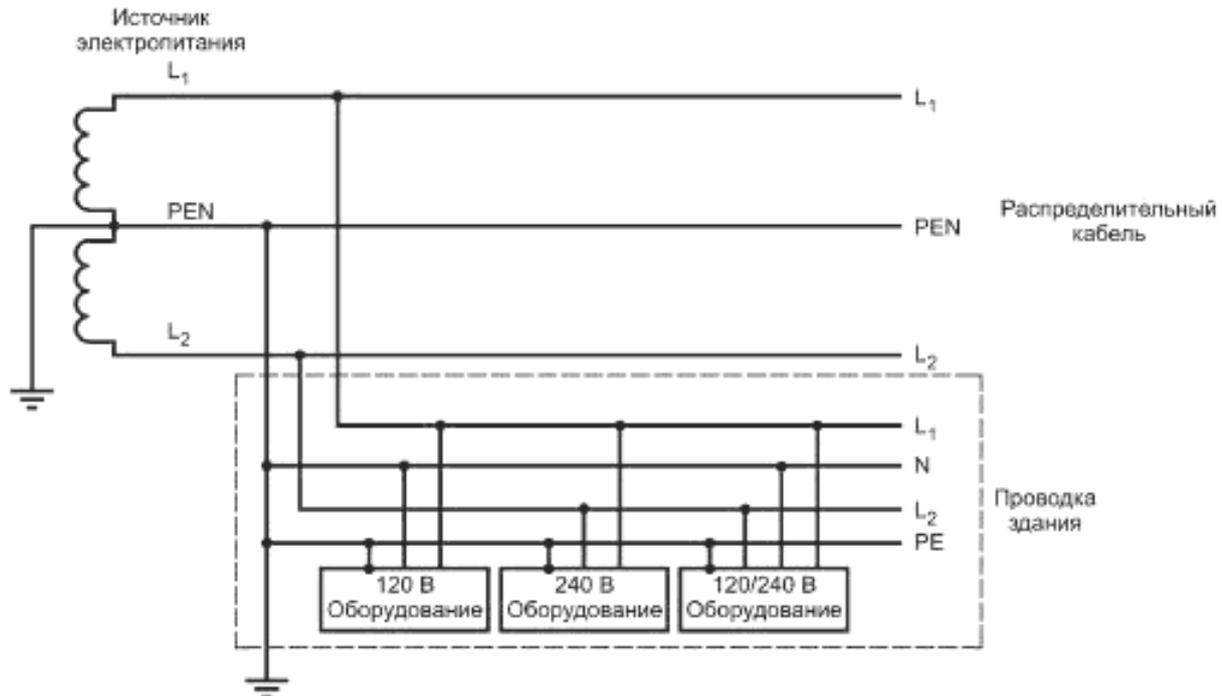
Защитные функции и функции нейтрали объединены в одном проводе (PEN).
