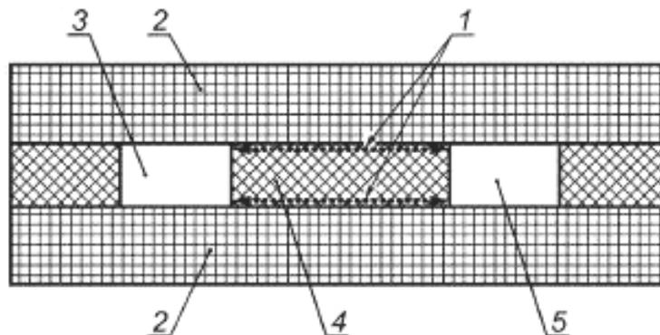
1 — потенциальный зазор и путь утечки вдоль скрепленного стыка; 2 — изоляционный слой; 3 — проводящая часть 1; 4 — изоляционный компаунд; 5 — проводящая часть 2
