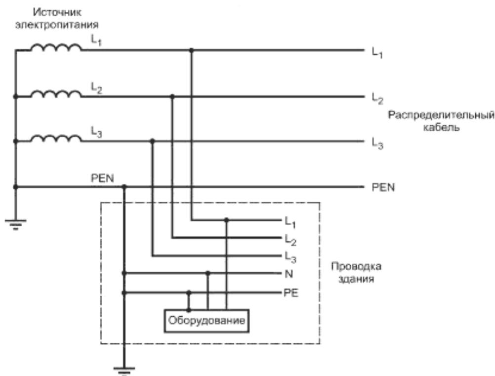
Один провод (PEN) объединяет в себе функции нейтрального и защитного проводов.
