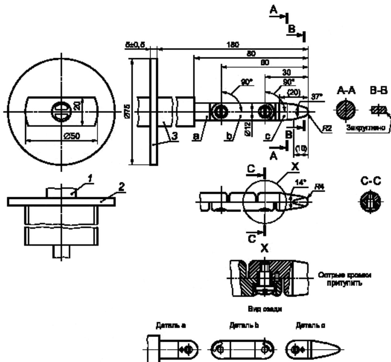
1 — рукоятка; 2 — стопорная пластина; 3 — изоляционный материал
