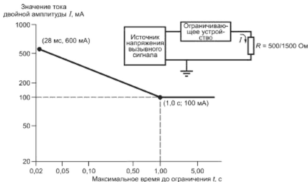
Рисунок М.4 — Пределы ограничения напряжения вызывного сигнала
