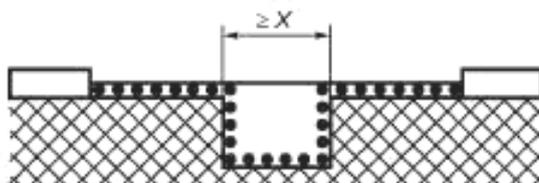
Условие: рассматриваемый путь включает в себя канавку с параллельными сторонами любой глубины, шириной не менее  $X$  мм.
