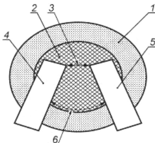
1 — изоляционная оболочка; 2 — изоляционный компаунд; 3 — расстояние через изоляцию; 4 — проводящая часть 1;
