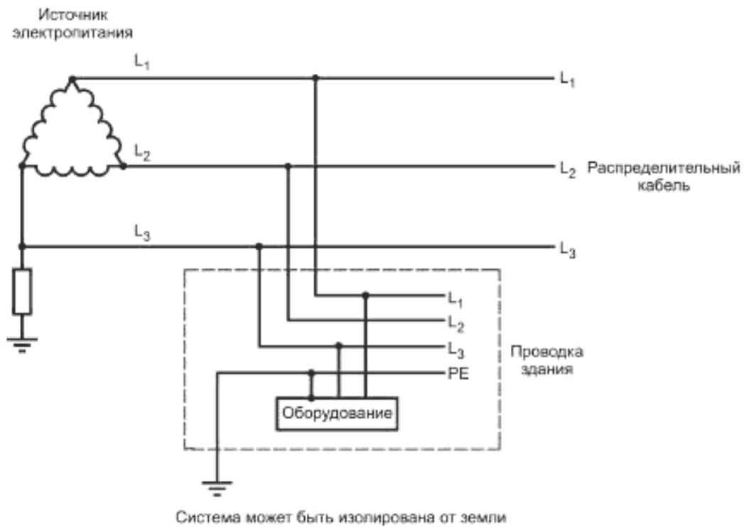
Рисунок V.8 — Пример IT-системы электропитания с тремя фазами
