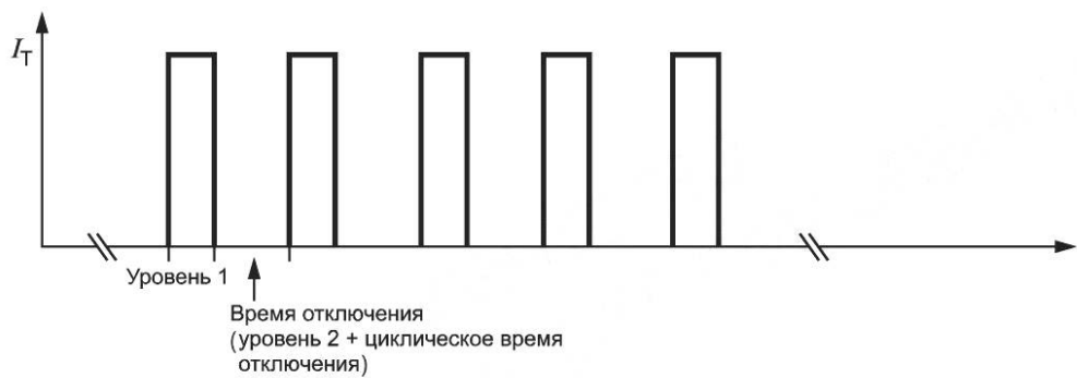
Характерный профиль испытательного тока AC-2a, AC-3a, AC-8a
