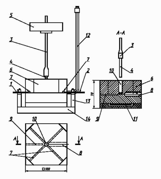
2 — образцы провода; 3 — поршень; 4 — керамическая насадка поршня; 5 — груз; 6 — металлический блок; 7 — прорези для размещения образцов; 8 — отверстие для ввода устройства контроля температуры; 9 — отверстие для ввода термопары; 10 — отверстие для ввода поршня с грузом; 11 — здектрический нагревательный элемент; 12 — устройство контроля температуры; 13 — изолированные выводы для присоединения образцов провода; 14 — изолирующее основание
