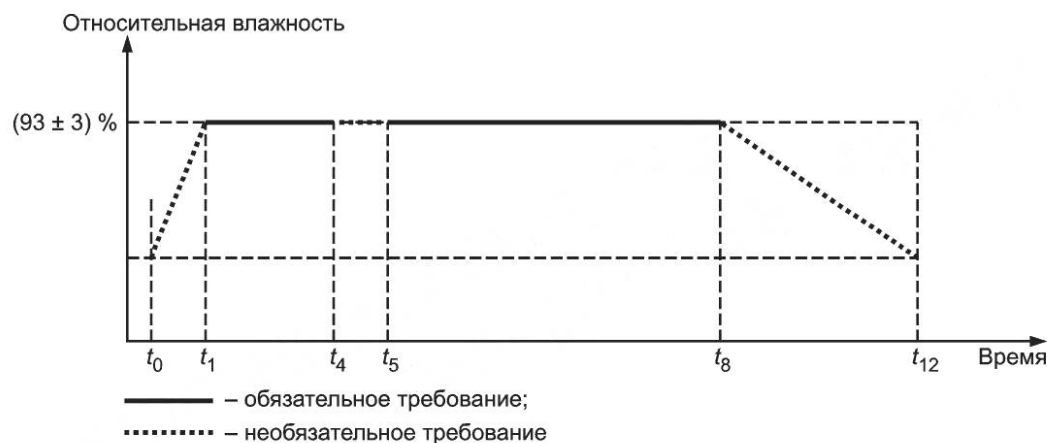
Рисунок J.4 — График изменения относительной влажности в климатической камере в течение одного рабочего цикла
