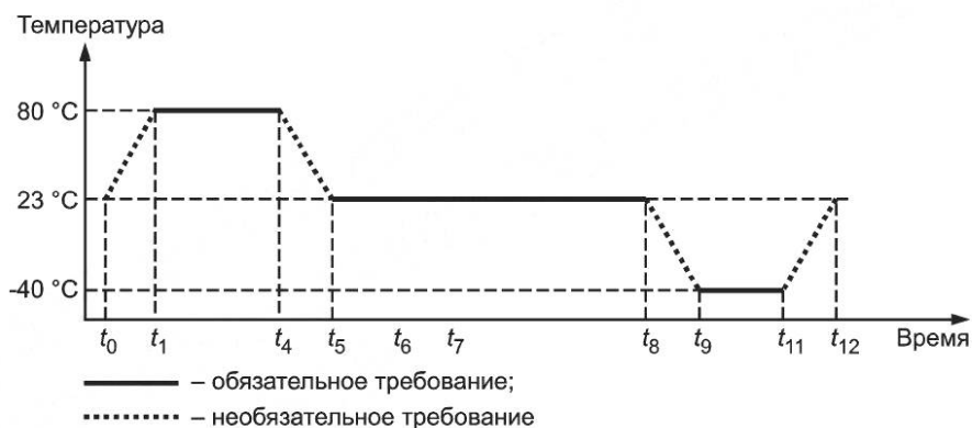
Рисунок J.3 — График изменения температуры в климатической камере в течение одного рабочего цикла
