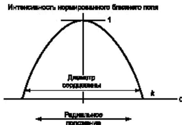
Рисунок С.1 – Диаметр поперечного сечения сердцевины. Сканирование интенсивности ближнего поля, способ 1
