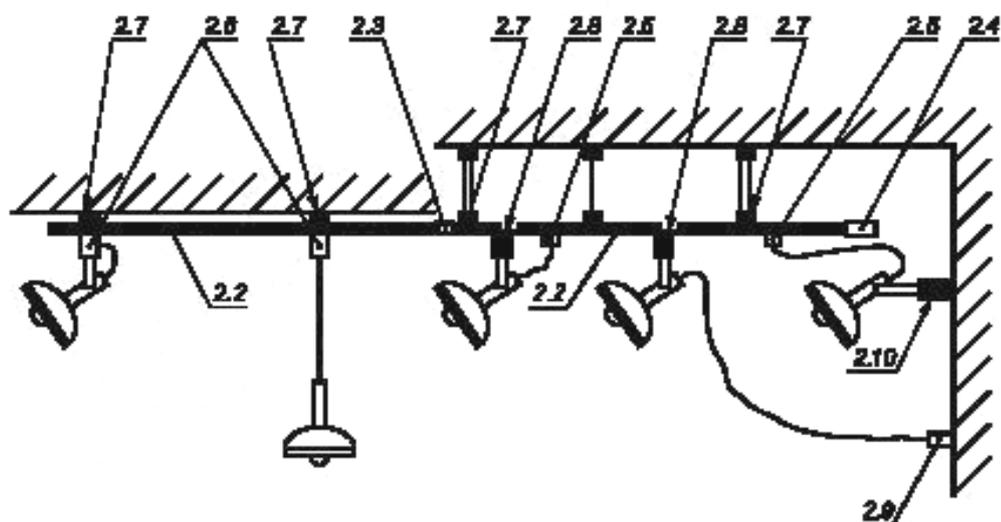
2.2 — секция шинпровода; 2.3 — соединитель; 2.4 — вводное устройство (может включать трансформатор); 2.5 — штепсель (питание только от секции шинпровода); 2.6 — адаптер для механического и электрического присоединения светильника к шинпроводу; 2.7 — подвес шинпровода (к потолку, к подвеске из труб или проволоки); 2.8 — подвес светильника; 2.9 — независимая коробка с розеткой; 2.10 — механическое закрепление светильника к стене
