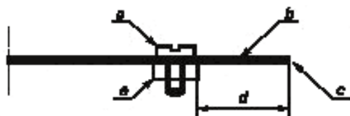
a — болт с отверстием 1 мм; b — стальная трубка; c — точка измерения; d = 32 мм; e — гайка
