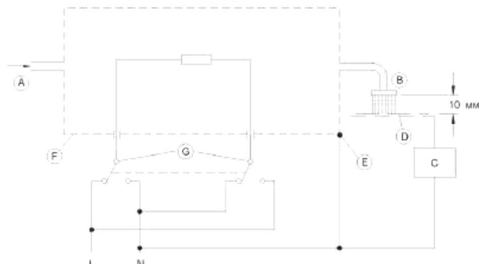
A – входная трубка; B – распылительная головка; C – цепь по МЭК 60990 (рисунок 4);
