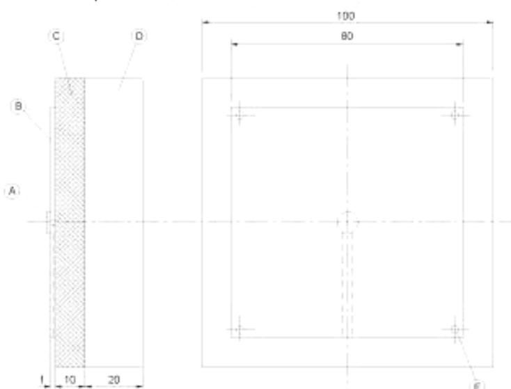
где: *A* – термопара крепится к центру медной пластины; *B* – квадратная медная пластина; *C* – теплоизоляционный материал; *D* – квадратный блок из древесины твердой породы; *E* – расположение крепежных отверстий
