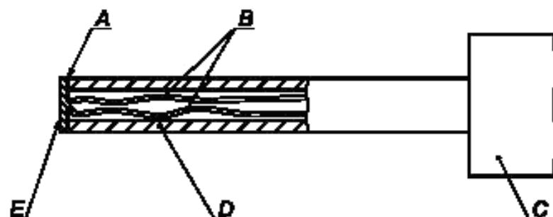
А – связывающее вещество; В – термопара из проволоки диаметром 0,3 мм типа К (хромоникелевый сплав) по IEC 807/02; С – ручное устройство, разрешающее контакт силой  $(4 \pm 1)$  Н; D – поликарбонатная труба с внутренним диаметром 3 мм, наружным диаметром 5 мм; Е – покрытый словом медный диск диаметром 5 мм, толщиной 0,5 мм.
