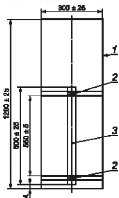
1 — металлическая камера; 2 — опорный стержень и крепление медной проволокой; 3 — образец; 4 — расстояние от дна камеры до нижнего конца образца (около 50 мм)
