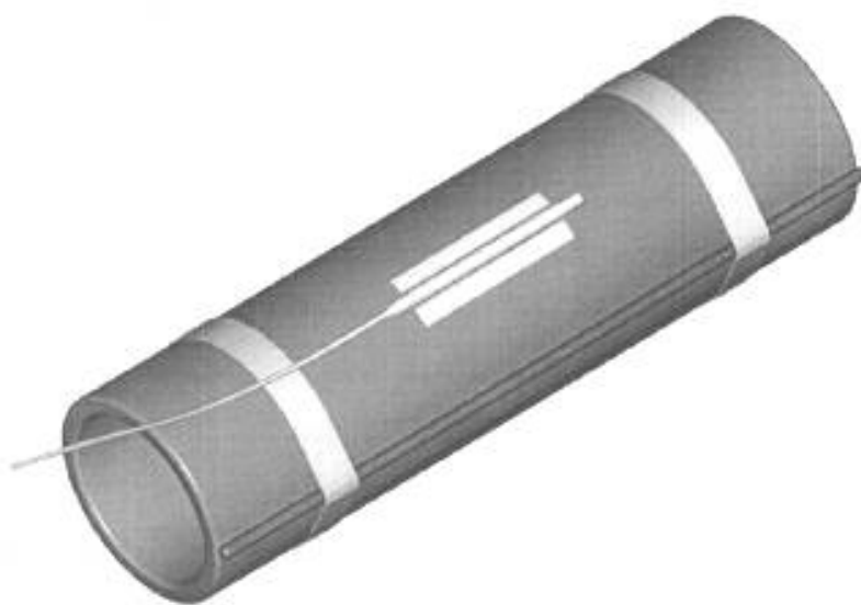
Рисунок 7 — Типичная установка датчика системы управления и датчика термореле
