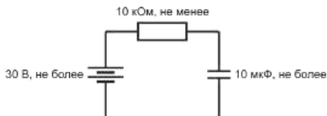
Рисунок А.8 — Простая емкостная цепь
