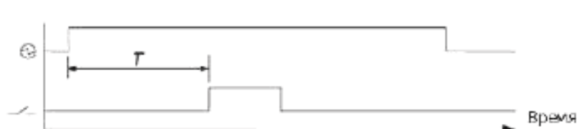
⊕ – источник электропитания; T – установленное время; ⏏ – главный контакт Рисунок 8 – Импульсное реле с задержкой
